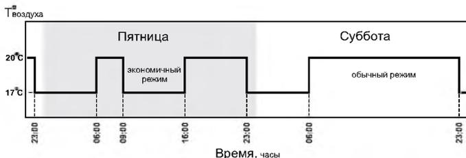
**Рис.7 График температуры воздуха в помещении для Режим 3.**
