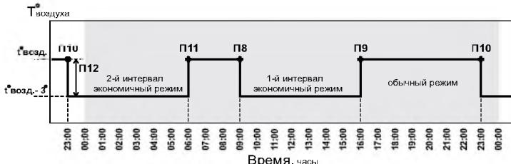
**Рис.5 График температуры воздуха в помещении для Режима 1.**
