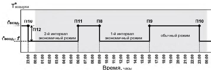
**Рис.5 График температуры воздуха в помещении для Режим 1.**
