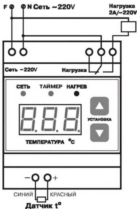
**Рис.2** Схема подключения терморегулятора
