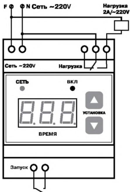
**Рис.2** Схема подключения реле времени
