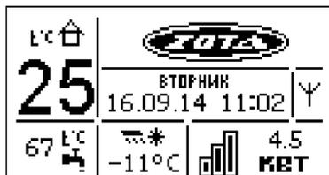
7.3. Во время отображения основного экрана нажатием кнопок “ВНИЗ” и “ВВЕРХ” можно переключиться на дополнительные экраны: “ВРЕМЯ”, “НАСОСЫ”.
