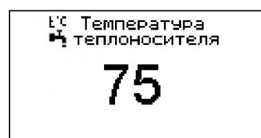
Если установлен контур ГВС в системе отопления, то температура теплоносителя должна быть установлена выше необходимой температуры ГВС. Если датчик температуры воздуха отключен или неисправен, котел будет поддерживать установленное значение температуры теплоносителя.
