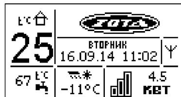
7.3. Во время отображения основного экрана нажатием кнопок "ВНИЗ" и "ВВЕРХ" можно переключаться на дополнительные экраны: "ВРЕМЯ", "НАСОСЫ".
