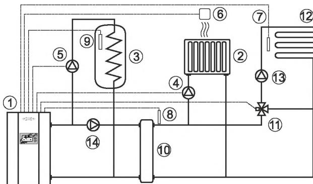
**Рис.7 Упрощенная схема подключения котла с гидроразделителем, контурами ГВС и теплого пола.**
