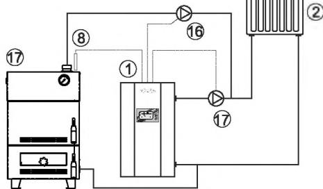
**Рис.6 Упрощенная схема подключения котла в режиме вспомогательного.**
