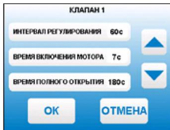
или дополнительного контура отопления. Для управления работой клапана 2 используется датчик температуры воды клапана (17). Также можно использовать датчик температуры воздуха клапана (19), если он не используется для клапана 1. Настройки клапана 2 аналогичны настройкам клапана 1.
