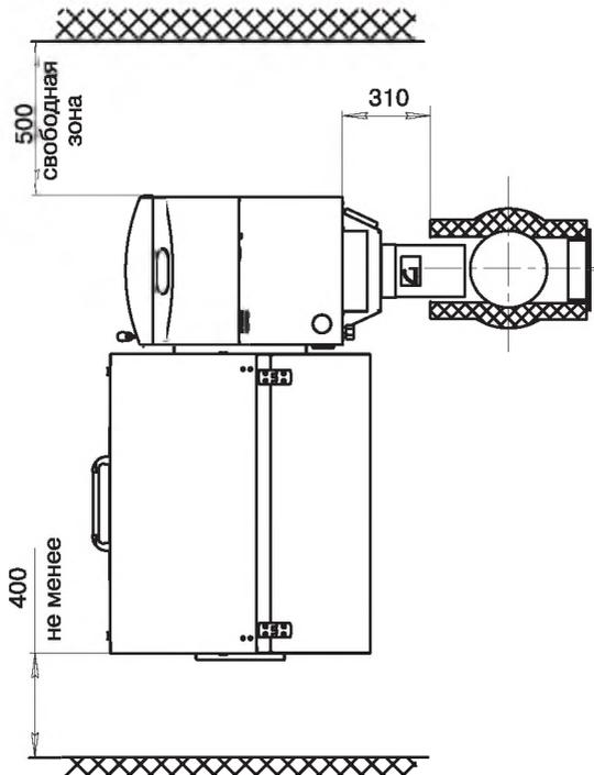
**Рис.7 Схема установки котла**
