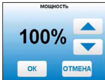
7.5.4. Для настройки максимальной температуры теплоносителя на выходе из котла выберите пункт меню “ $t^{\circ}\text{C}$  подачи”. В пункте меню задается температура теплоносителя, которую будет поддерживать котел. Рекомендуемая температура теплоносителя не менее  $70^{\circ}\text{C}$ .
