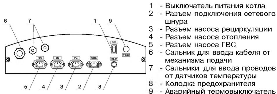
**Рис.5 Расположение органов управления на задней панели пульта**
