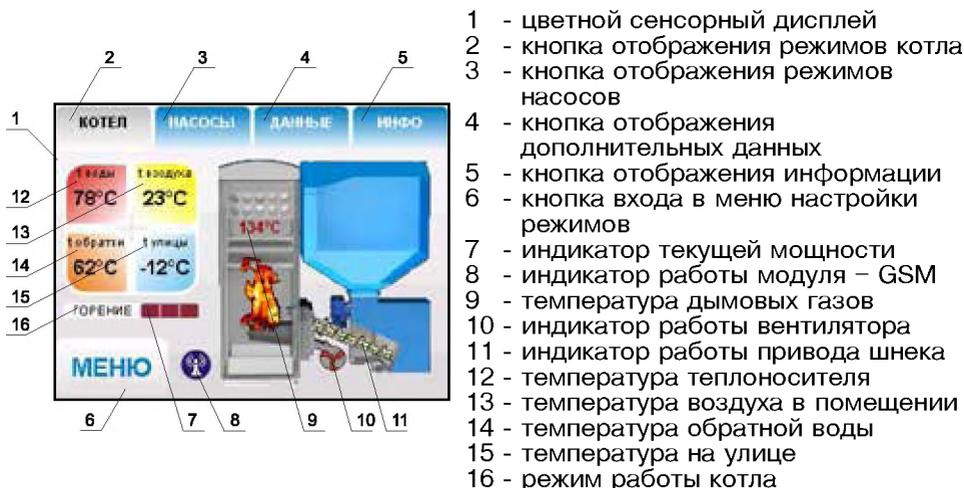
**Рис.6 Расположение органов управления и индикации на передней панели пульта**
