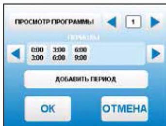
7.5.19. Для настройки каждого периода необходимо установить время его начала и конца а также выбрать режимы регулировки: по воде, воздуху в помещении, либо режим паузы. Время задается с точностью до часа. Если выбрана регулировка по температуре, то необходимо установить температуру, которую нужно поддерживать. Для удаления периода, нужно нажать кнопку "УДАЛИТЬ ПЕРИОД". После того как установки произведены, следует нажать кнопку "ОК" для сохранения настроек.
