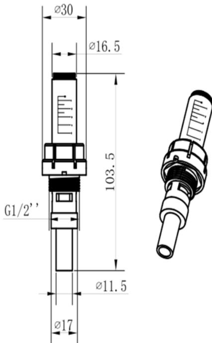
**Рис. 3. Габаритные размеры настроечного клапана с расходомером**
