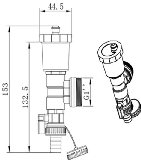
**Рис. 2. Габаритные размеры концевой фитинга с автоматическим воздухоотводчиком и сливным краном (Таблица 2)**
