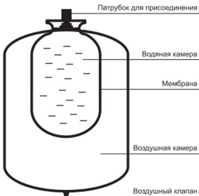
**Рис.1 Конструкция бака**
