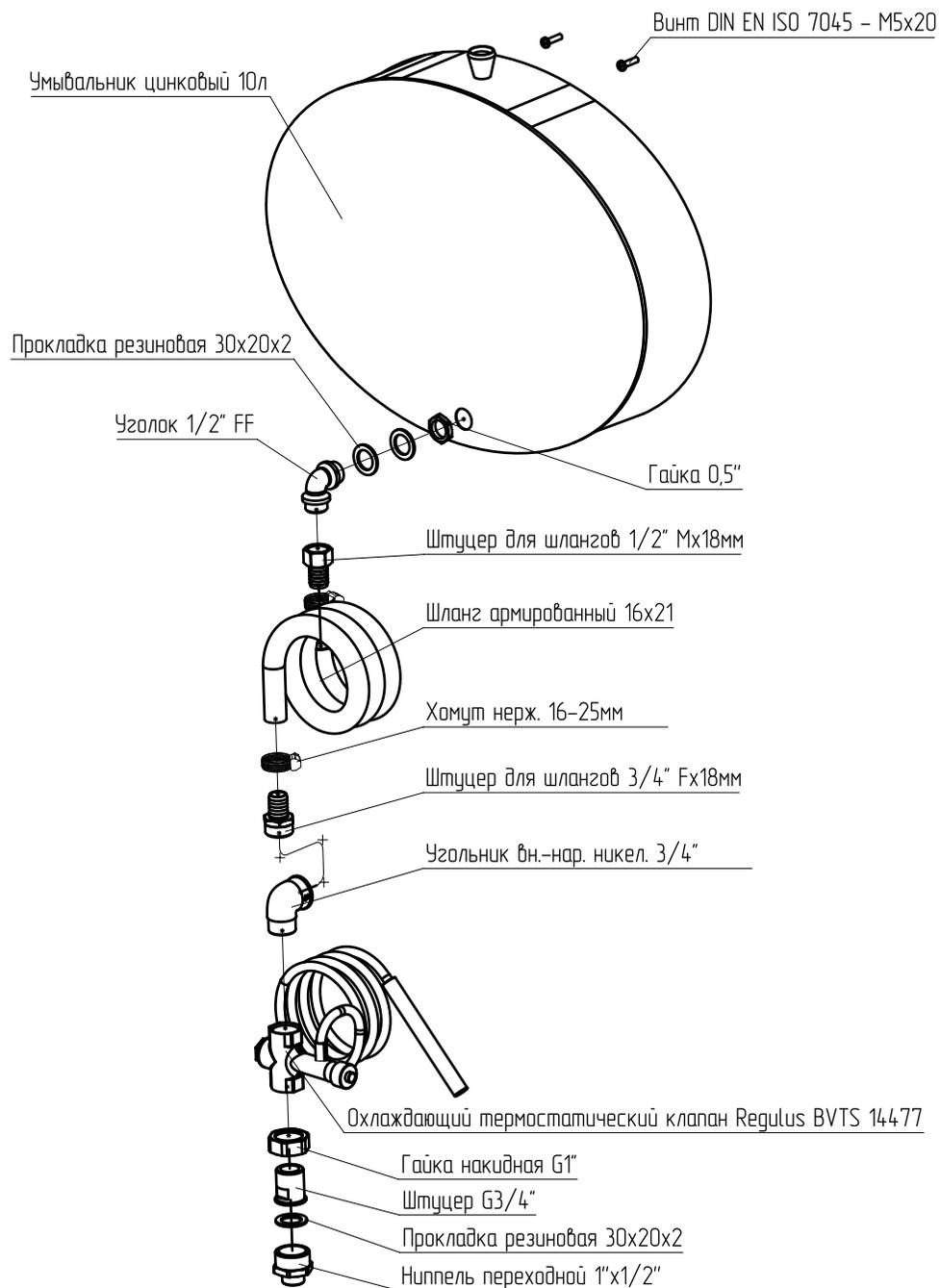
Рис.1 Схема сборки системы охлаждения топливопровода.
