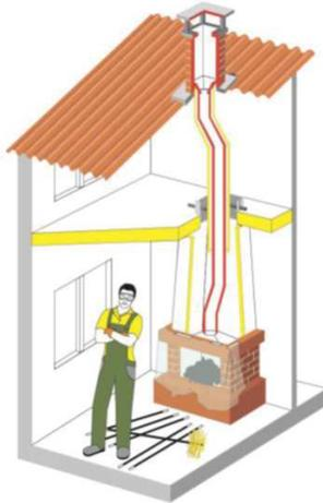
4.13. После завершения работ по чистке дымохода снимите защитную пленку с арки дверцы отопительного прибора и с помощью фонарика (при необходимости зеркала) осмотрите полость дымохода на наличие наслоений сажи в дымоходе. Если наслоения сажи остались, повторите чистку.
