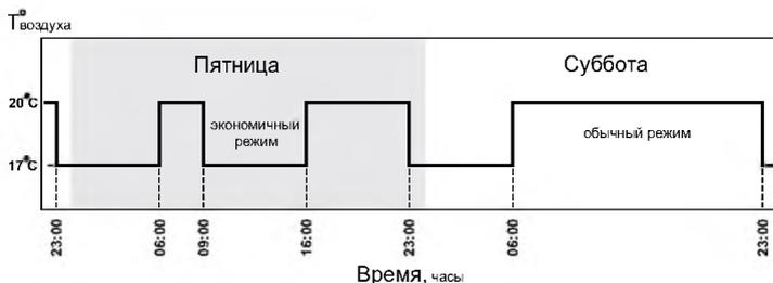
**Рис.6 График температуры воздуха в помещении для Режима 3.**
