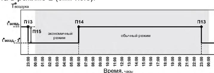
**Рис.5 График температуры воздуха в помещении для Режим 2.**
