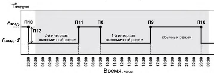
**Рис.4 График температуры воздуха в помещении для Режим 1.**
