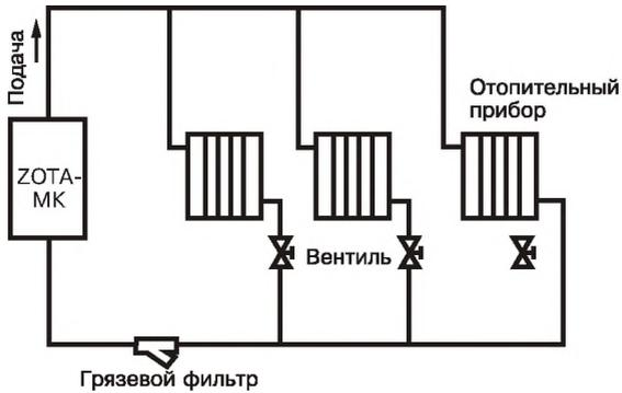
**Рис.5 Упрощенная схема подключения миникотельной в отопительную систему.**
