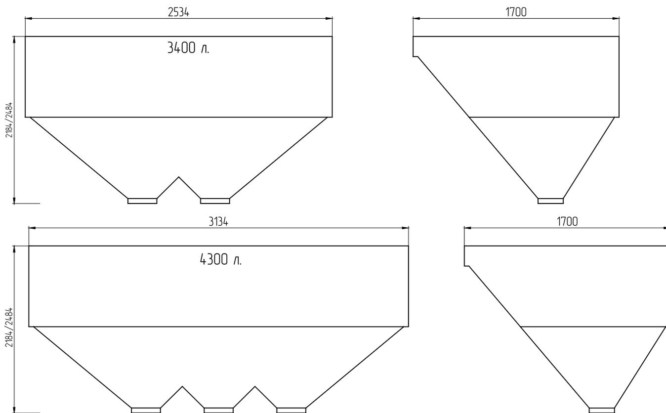
**Рис.1.1 Формы и размеры бункеров 3400 и 4300 л**
