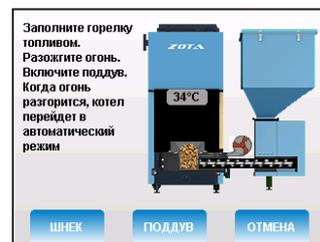
Так же можно произвести настройку котла самостоятельно воспользовавшись меню коррекции горения п.п.8.8.6 настоящего документа. После коррекции горения факел пламени должен быть равномерным, желтого цвета. Дымления из корпуса котла, механизма подачи и бункера, а также дымовой трубы не должно быть.
