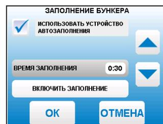
Если устройство заполнения не используется (галочка в соответствующем поле не установлена), выход (Прил.1 поз.14) платы управления можно использовать для индикации опустошения бункера. Когда уровень топлива опустится до нижнего датчика на экране появляется соответствующее сообщение и на выход (Прил.1 поз.14) подается сигнал о низком уровне топлива. Сигнал продолжается до тех пор, пока уровень топлива не станет выше датчика опустошения бункера.
