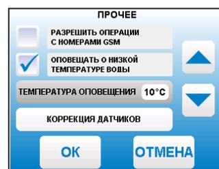
В данном меню можно скорректировать показания датчика температуры воздуха в помещении, датчика воздуха на улице и датчика воздуха клапана для обеспечения более точных показаний в различных условиях эксплуатации. В меню «КОРРЕКЦИЯ ДАТЧИКОВ» выберите необходимый датчик и установите температуру поправки в диапазоне +/-5°C.
