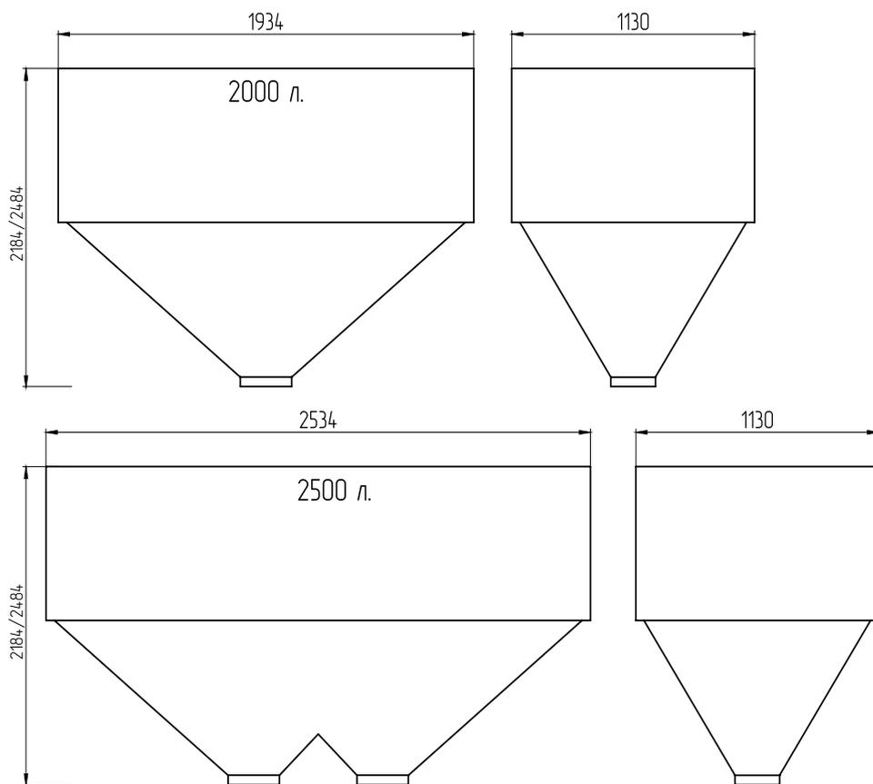
**Рис.1 Формы и размеры бункеров 2000, 2500 л**
