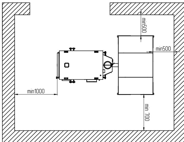
**Рис.10 Расположение котла в помещении котельной**
